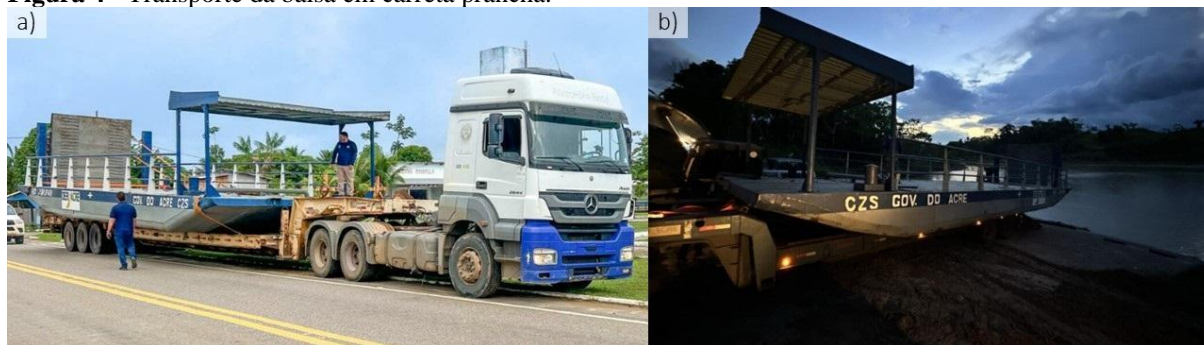
Figura 4 - Transporte da balsa em carreta prancha.
