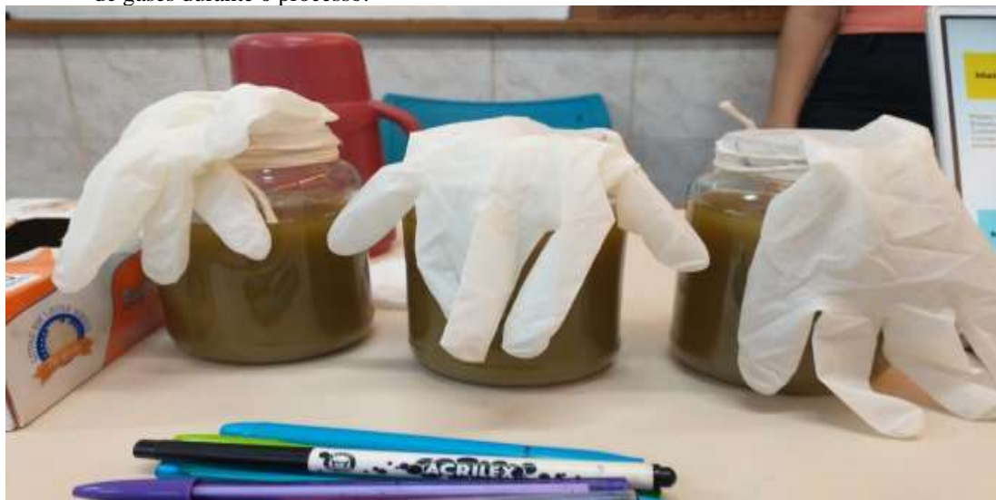
Figura 1 - Imagem do experimento de produção de etanol. As luvas presas nos potes indicarão a formação de gases durante o processo.
