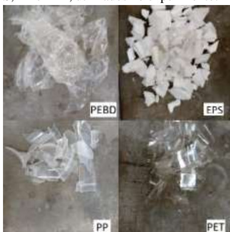
Figura 2 - Plásticos PEBD, EPS, PP e PET, utilizados no experimento.
