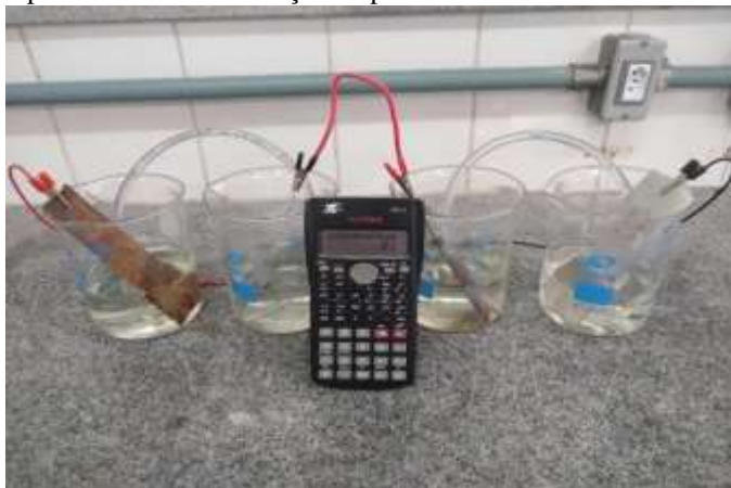
Imagem 2 - Aplicação prática de uma associação de pilhas em série.
