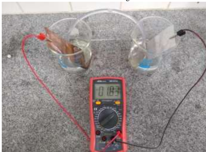
Imagem 1 - Pilha montada com multímetro mostrando a voltagem.
