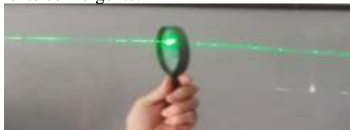
Figura 6 - Visualização da trajetória da luz em lente convergente.
