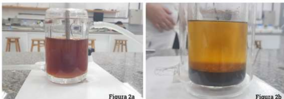
Figura 2 – a) Aquecimento e agitação da mistura de reagentes no reator encamisado; b) Resfriamento em temperatura ambiente da mistura entre o óleo residual, metanol e o catalisador.
