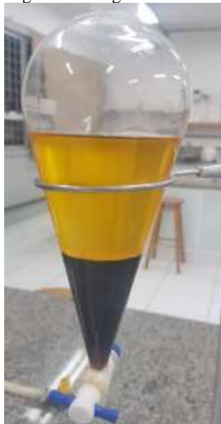
Figura 3 – Separação do biodiesel e da glicerina originada como subproduto.
