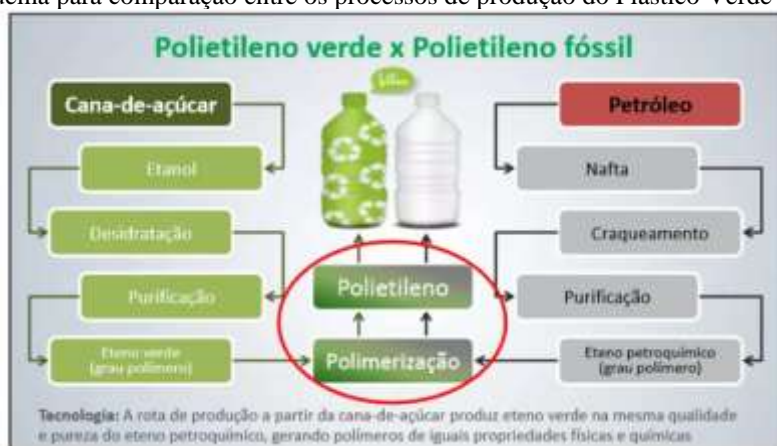
Figura 2 – Esquema para comparação entre os processos de produção do Plástico Verde e do Plástico.
