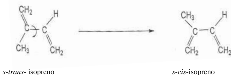
Figura 4 - Ressonância do 2-metil-1, 3-butadieno (isopreno)
