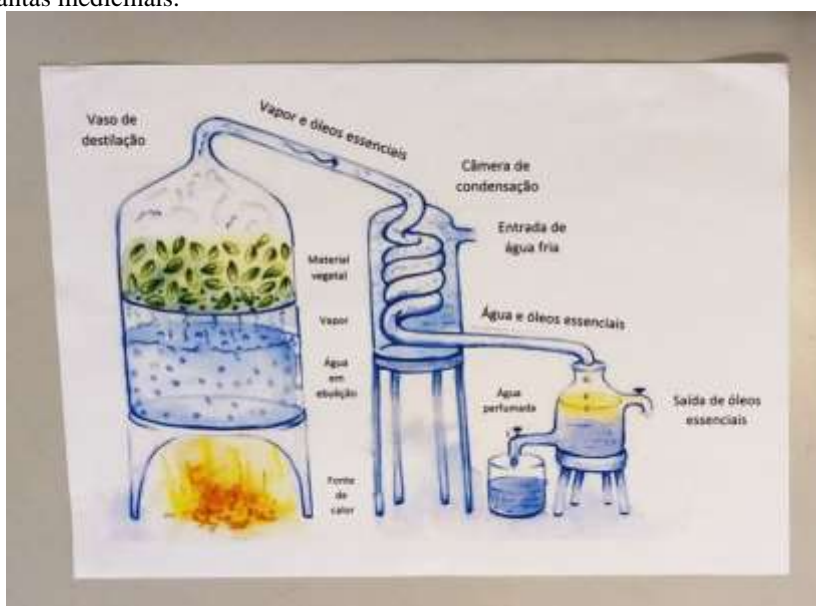
Figura 1 - Representação do processo de arraste a vapor para obtenção de óleos essenciais a partir das plantas medicinais.
