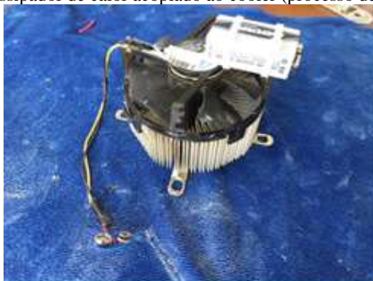
Figura 5 - Dissipador de calor acoplado ao cooler (processo de resfriamento).
