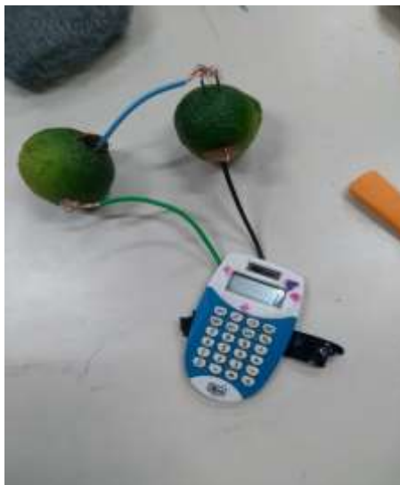
Figura 2 - Limões conectados à pilha funcionando.
