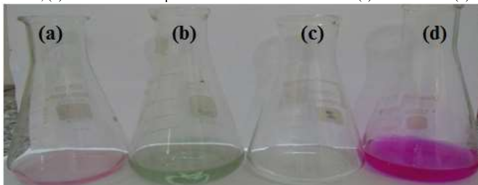
Figura 5 – Coloração obtida no ponto final da titulação para a flor de M. lathyroides (L.) Urb (a) em meio ácido, (b) em meio básico e para a fenolftaleína em meio ácido (c) e meio básico (d)
