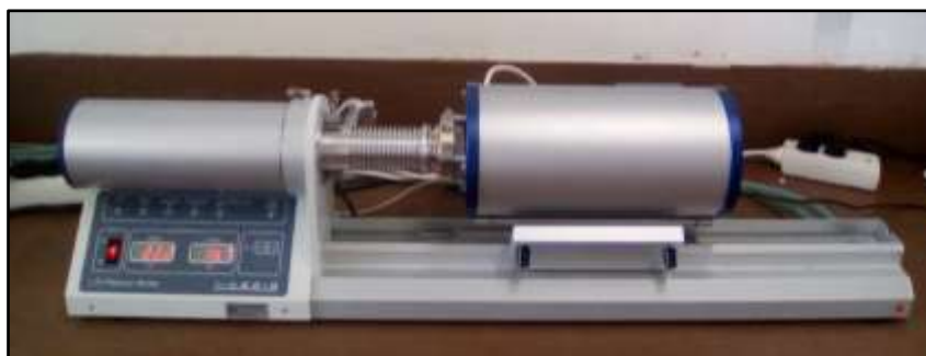
Figura 3 - Dilatómetro utilizado en el estudio
