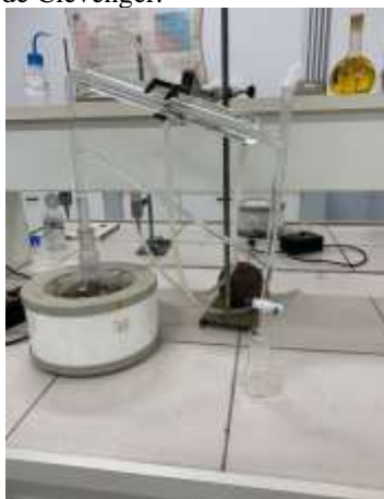
Figura 1 - Hidrodestilação em aparelho de Clevenger.
