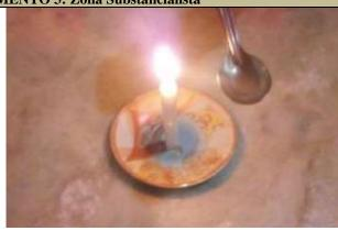
Metodologia Experimental: Utilizar o estilete para retirar alguns pedaços da parafina do corpo da vela e colocar sob a colher de metal. Depois, fixar a vela no pires e acender o pavio, utilizando o isqueiro ou fósforo. Posicionar a colher sobre a vela e observar que, após alguns segundos, a parafina vai mudar de estado físico, de sólido para líquido. Por fim, afastar a colher da fonte de calor e observar a solidificação do material
