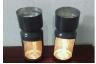
Metodologia Experimental: Nos dois recipientes iguais, adicionar quantidades diferentes de água e aquecer, com a vela, os dois pelo mesmo tempo. Após cerca de cinco minutos, verificar as temperaturas em cada recipiente, com o termômetro para verificar qual amostra de água está a uma maior temperatura. O recipiente com menos água é o que aquece mais rapidamente.
