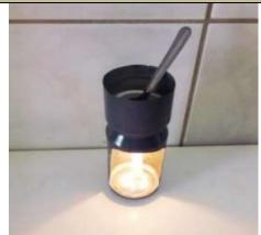
Metodologia Experimental: Com a vela acoplada ao sistema, aquecer uma quantidade de água e, em seguida, colocar a colher em contato com o líquido. Após 10 minutos, observar a temperatura da colher.
