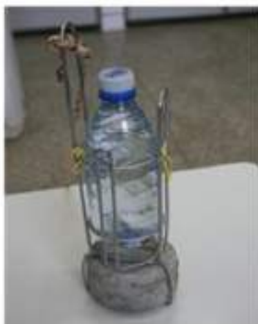
Figura 3- Coletor de água subterrânea. Fonte: Os organizadores.
