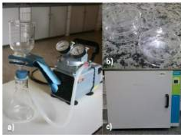
Figura 4- a) Bomba a vácuo e sistema Kitassato, b) Placa de, Petri c) Estufa bacteriológica. Fonte: Os organizadores
