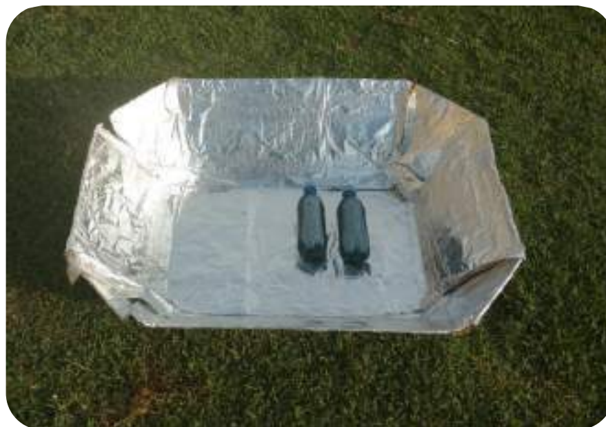
Figura 3- Concentrador de raios solares.
