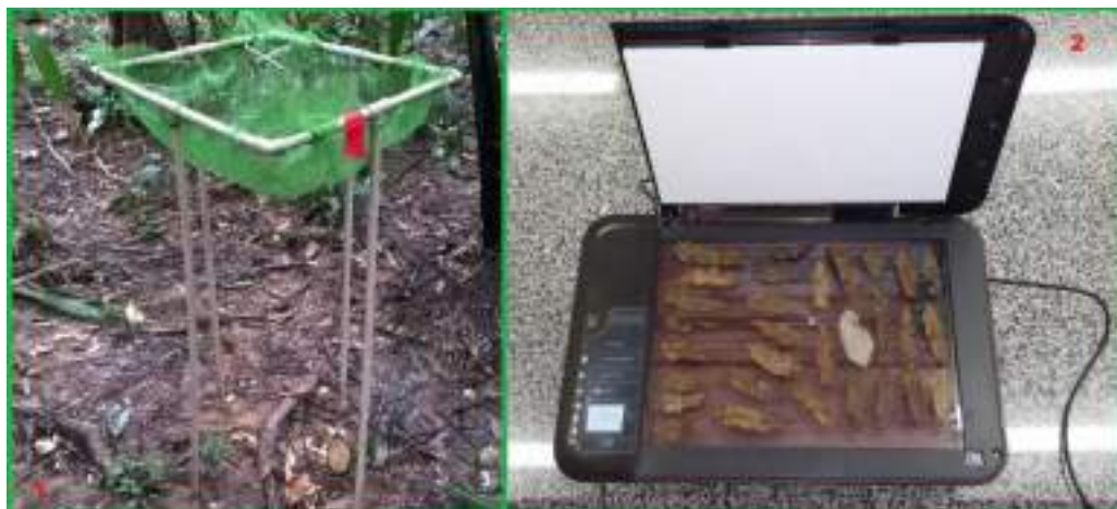
Figura 3 - Coletor de serapilheira (1) e folhas sobrepostas na tela da impressora para digitalização (2).
