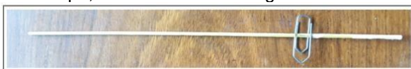
Fig. 16 - Clipe de papel fixado perpendicularmente à vareta cerca de 10 cm da ponta onde estava o “motor”. Fonte: [1]
