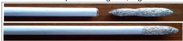
Fig. 7 – Colocação da coifa (ponta) no tubo do foguete. Fonte: [1]
