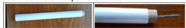
Fig. 3 – Tubo do foguete (esquerda). Tubo do foguete com o motor na ponta (direita). Fonte: [1]
