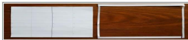
Fig. 8 – Folha das aletas já recortadas as bordas. Fonte: [1]
