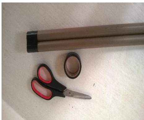
Imagem 1: Colando os canos em paralelo com a fita adesiva.
