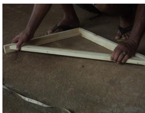
Imagem 4: Pregando o terceiro pedaço de madeira para dar suporte ao fixar a pista.
