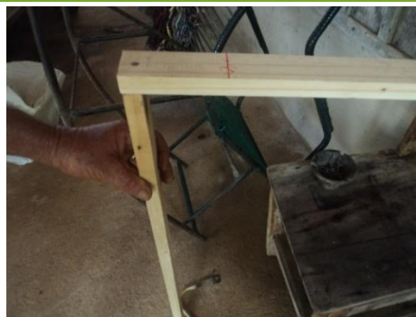
Imagem 2: Pregando as duas madeiras em formato de L:
