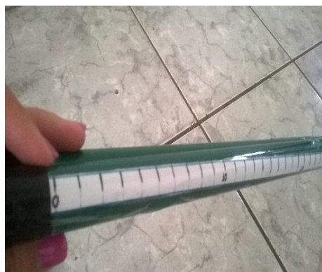
Imagem 2: Colando a fita métrica de papel na lateral do cano.
