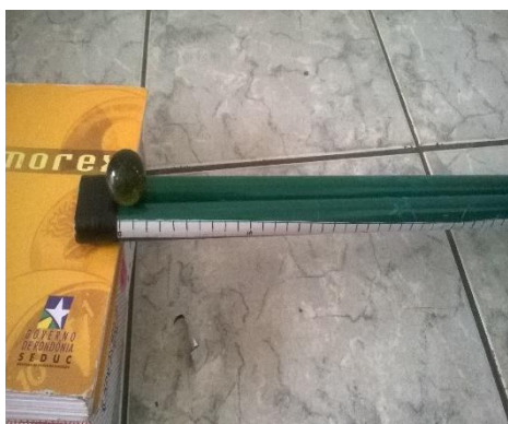
Imagem 3: Colocando o calço sob os canos de modo que a bolinha escorregue com movimento acelerado.
