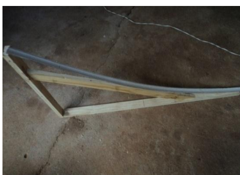
Imagem 5: Cortando o PVC em formato de uma curva, pregou na parte superior há inferior como na imagem acima..
