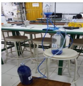
**Figura 2:** Representação experimental da fonte de Heron. Imagem registrada no Laboratório de Química da UFAM. Fonte: autores.
