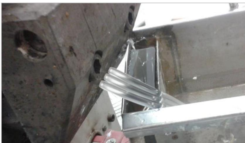
**Figura 11** – Detalhe da saída do polímero fundido pelos orifícios da matriz tripla. (Fonte: Autor, 2020).
