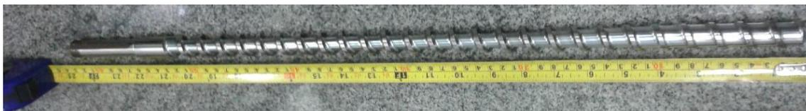
**Figura 6** – Parafuso sem-fim. (Fonte: Autor, 2020).
