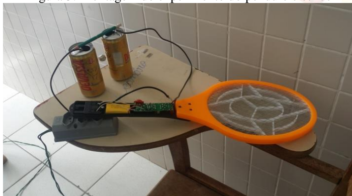
Figura 5: Montagem do experimento do pendulo elétrico
