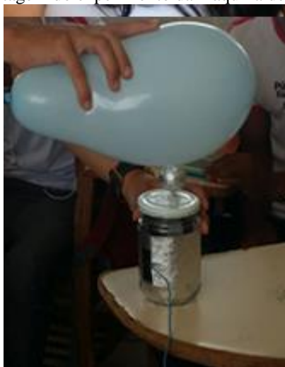
Figura 5: Montagem do experimento da máquina de choque caseira
