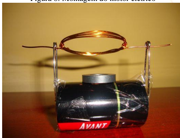
Figura 6: Montagem do motor elétrico
