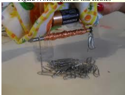
Figura 7: Montagem do imã elétrico
