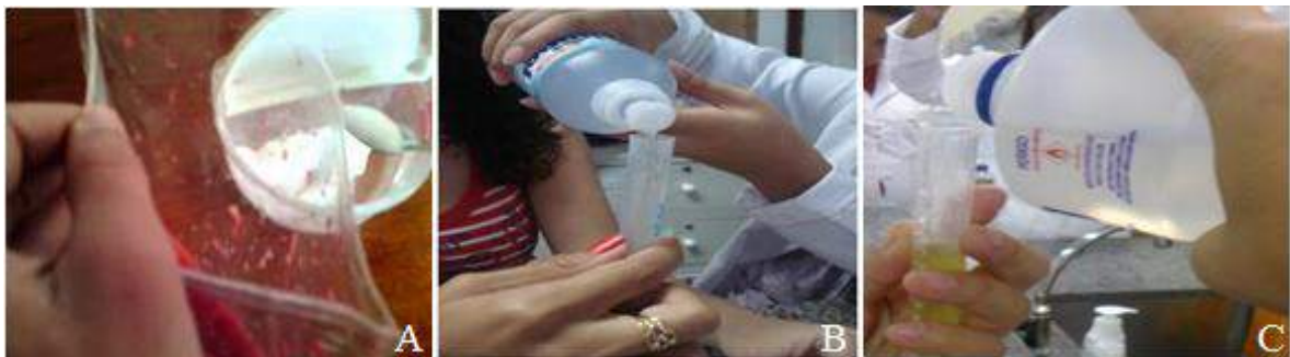
Figura 02 - Etapas do Experimentos: A, adição de sal; B, adição do detergente; C, adição do álcool gelado. Fonte: AUTORAS, 2016.
