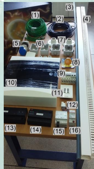
Figura 11 – Componentes utilizados no modelo prático. (1) Cabo Bus KNX; (2) Cabo PP 4x2,5mm 2 ; (3) Eletroduto PVC ½"; (4) Canaleta Ventilada; (5) Tomada Industrial 16"; (6) Caixa 4x2"; (7) Plafon E27; (8) Lâmpada Dicroica 50W; (9) Disjuntor Monopolar 16A / Bipolar 20"; (10) Quadro de Distribuição; (11) Controlador Push-Button 4-gangs plus; (12) Entrada Binária 4-gangs plus; (13) Dimmer Universal 2 Canais, 230VA; (14) Saída Binária 250VA 8x10A; (15) Fonte de Alimentação KNX 640mA; (16) Interface USB/KNX – N148/11
