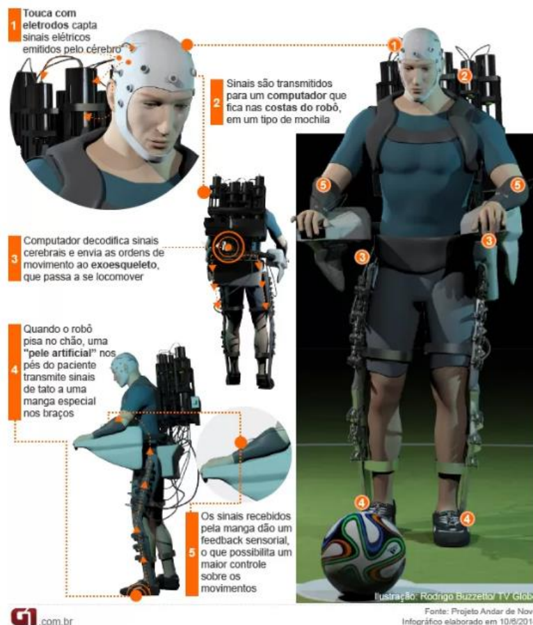
Imagem 1: Infográfico do funcionamento do exoesqueleto
